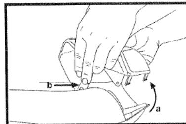
3. Повернуть лицевую панель вверх и назад (а). Нажать внутрь с двух сторон на поворотные точки до освобождения со штифтов и снять лицевую панель (b).
