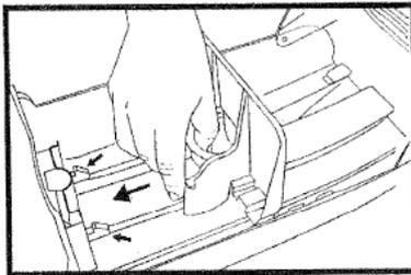
2. Удерживая пальцем, передвинуть прижимную панель в заднюю часть устройства до сцепления с зубьями фиксатора.
