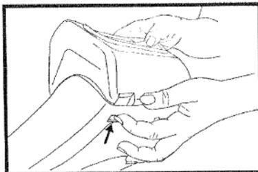
2. Найти 2 фиксатора под передней частью лицевой панели и нажать вверх по одному.
