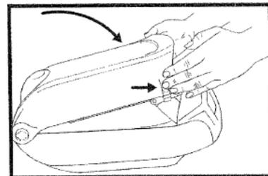
4. Закрыть крышку. **ПРИМЕЧАНИЕ:** Каретка прижимной панели автоматически спускается при закрытии крышки, прижимая салфетки.
