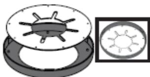
7. Установить накладное кольцо с уплотнителем на монтажное кольцо, поворачивая по часовой стрелке, пока оно не будет зафиксировано.
