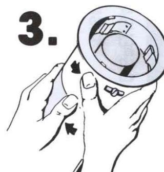
**3.** Поворачивать шайбу против часовой стрелки, пока настраивающий зажим не будет надежно удерживать стаканчики. Затянуть фиксирующий винт. НЕ ПОДГИБАЙТЕ ЗАЖИМЫ ВРУЧНУЮ!
