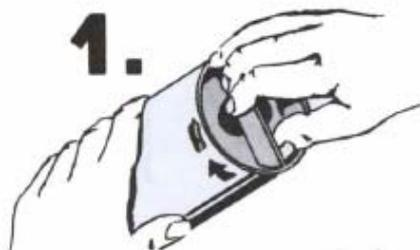
**1.** Извлечь блок пружины, повернув пластиковое основание по часовой стрелке до освобождения выступов из вырезов. Осторожно вытянуть.
