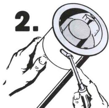
**2.** Ослабить фиксирующий винт и загрузить стаканчики в диспенсер.
