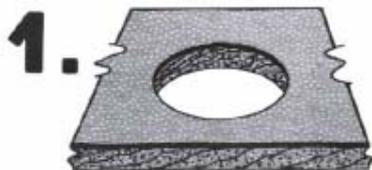
**1.** Вырезать отверстие, соответствующее выбранному диспенсеру. Чтобы определить требуемый диаметр отверстия, см. строку E в таблице характеристик.
