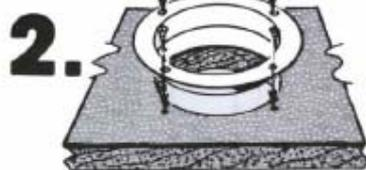
**2.** Надежно закрепить монтажное кольцо в отверстии с помощью входящего в комплект крепежа.
