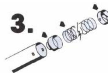
**3.** Собрать устройство, вставив держатель стаканчиков, пружину и нижнюю часть и убедившись, что выступы вошли в прорези. Перед установкой проверить настройку.
