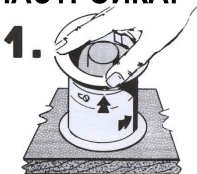
**1.** Извлечь диспенсер из прилавка, повернув против часовой стрелки и вытянув из отверстия.
