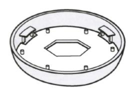
6. УСТАНОВИТЬ ПОКРОВНОЕ КОЛЬЦО С УПЛОТНИТЕЛЕМ, ПОВОРАЧИВАЯ ПО ЧАСОВОЙ СТРЕЛКЕ НА МОНТАЖНОМ КОЛЬЦЕ ПОКА НЕ ЗАФИКСИРУЕТСЯ
